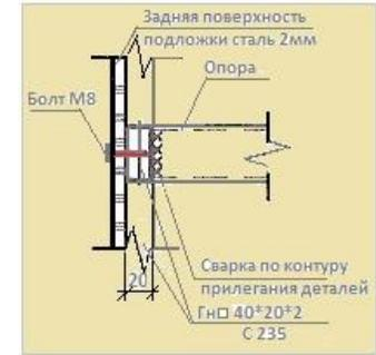
Способ крепления крышной конструкции объемных букв, панель-кронштейн (в виде креста, прямоугольника или окружности с крестом) на здании магазина. Вид сбоку.
